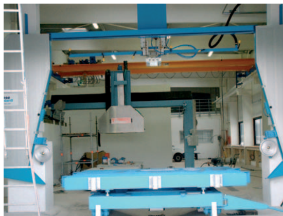
▲ Monofil Bideseimpianti et débiteuse TC 14 Thibaut/Calas Ø 1,6 m dans les ateliers de l'entreprise Normandie Rénovation.
